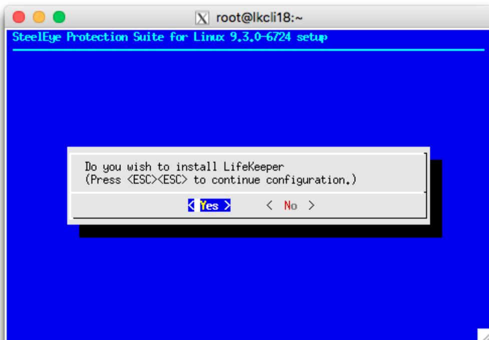
問題がなければ **<Yes>** を選択、アップデートを実施してください。アップデート完了後、「Setup Complete.」が出力されればアップデートは完了です。アップデートに失敗した場合は対応したエラーメッセージが出力されます。問題を解決した上で再度アップデートを実施してください。
